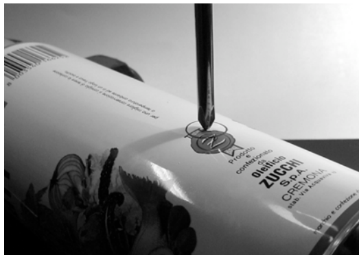
Figure 4.36: Marquez le trou avant de percer.
