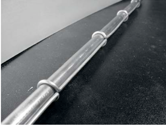
Figure 4.21: L'insertion d'un tuyau peut aider à redresser le fil.
