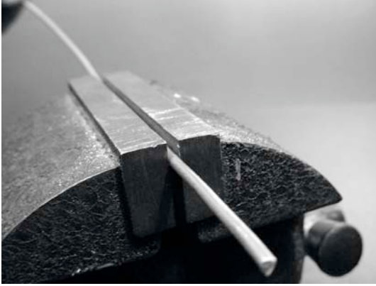
Figure 4.15: Rendez le fil de fer aussi droit que possible.
