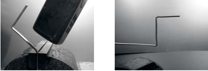
Figure 4.17: Plier le fil en forme de « Z ».
