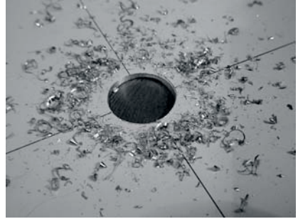
Figure 4.22: Percer un trou dans la plaque métallique.
