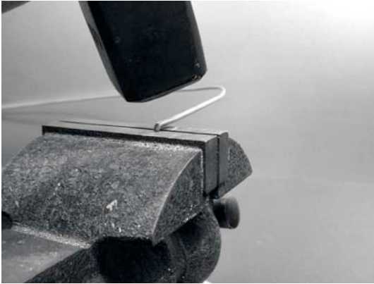
Figure 4.16: Frapper doucement sur le fil pour faire une courbe fermée.
