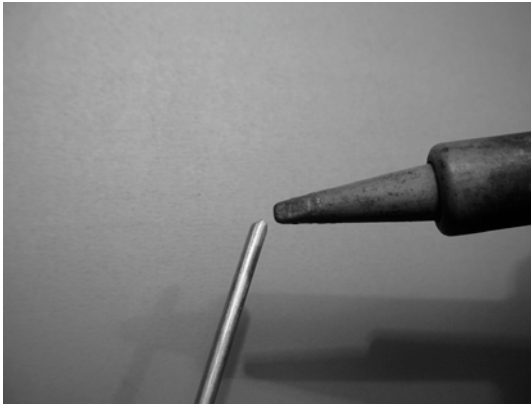
Figure 4.38: Ajouter de l'étain à l'extrémité du fil avant de souder.
